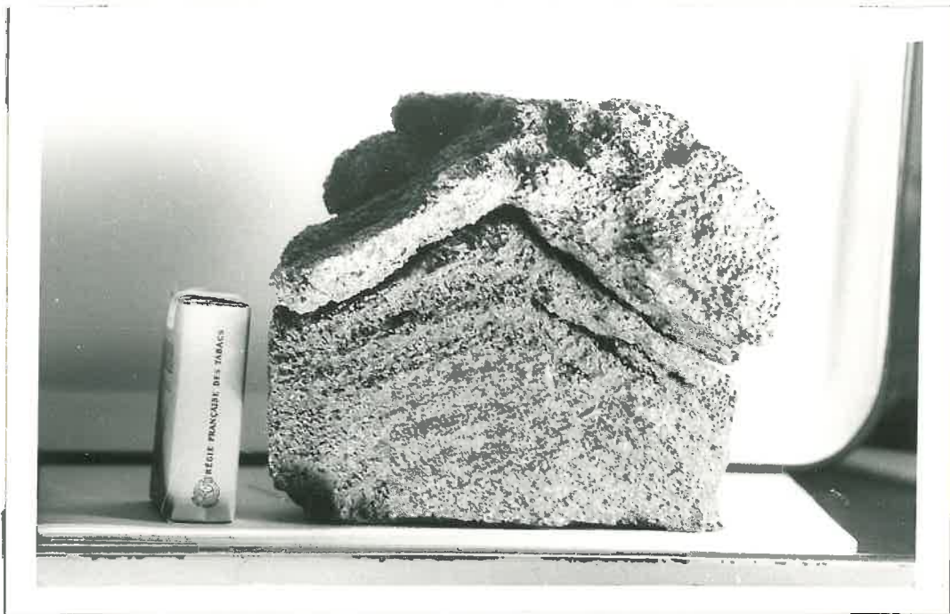
PHOTO n°9 : Coupe longitudinale d'une colonne de terre de Lunéville montrant un litage formé sous l'effet de l'évaporation sous lampe.
