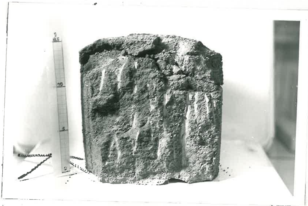
PHOTO n°11 : Coupe longitudinale d'une colonne de terre prise en masse à la dessiccation (terre de Lunéville)
