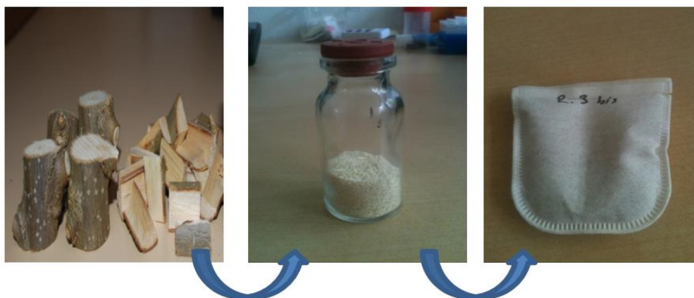
Figure 6 : Différentes étapes suivies par la poudre de bois du broyage à la mise en sachet
