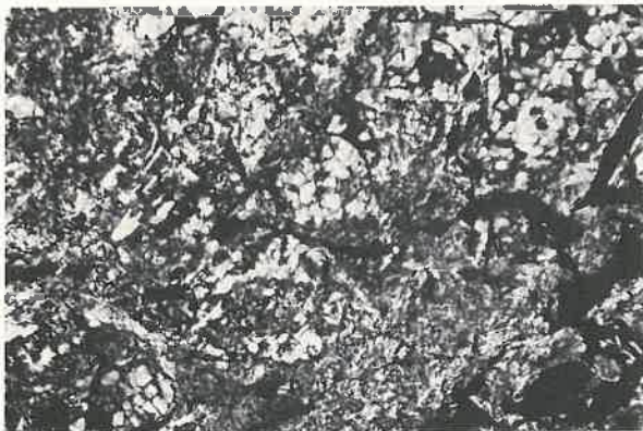
5. L.P. — Horizon B (80 cm). Les fissures sont plus nombreuses, les quartz très fracturés. Des domaines orientés apparaissent dans le fond matriciel, en bordure des vides.
