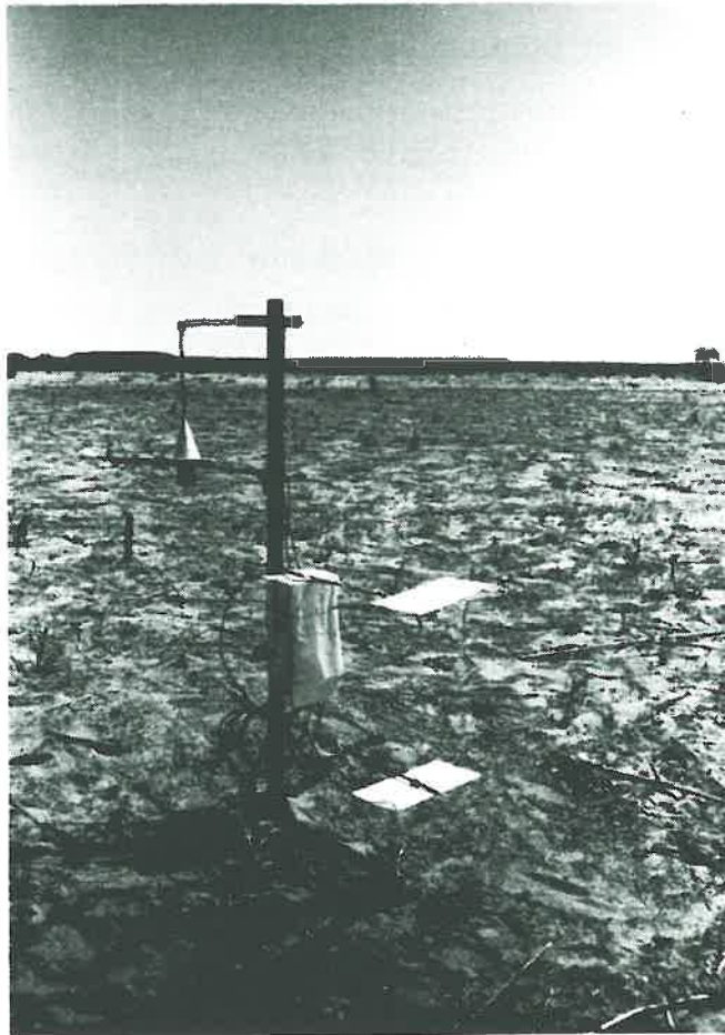
Photo 4: Dispositif de mesure des flux de la surface du sol nu.
