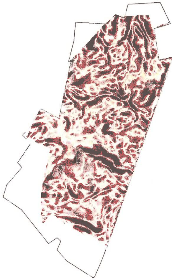
Figure 10.4 : Carte des différences entre les orientations de la pente issues du MNA estimé à partir du levé topographique et les orientations de la pente issues du MNA estimé à partir de la carte topographique.
