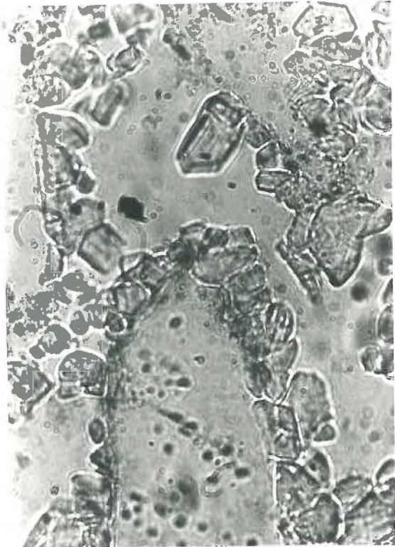
Zone d'évaporation brusque, petits cristaux tapissant la surface des grains de sable.
