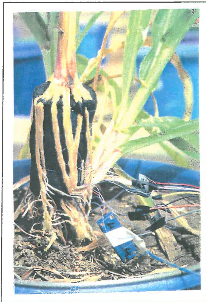
Photo : Formation de racines recouvrant et endommageant le capteur
