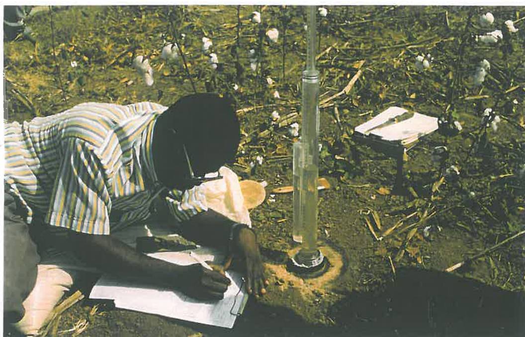
Photos n° 7 et 8 : Infiltromètres (TRIMS) en cours d'utilisation. Photo n° 7 (haut) : embase de grand diamètre moyen et photo n° 8 : embase de diamètre moyen.
