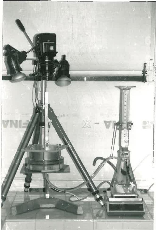
**Photo 1 :**     **Système d'humectation de massif cylindrique.**
