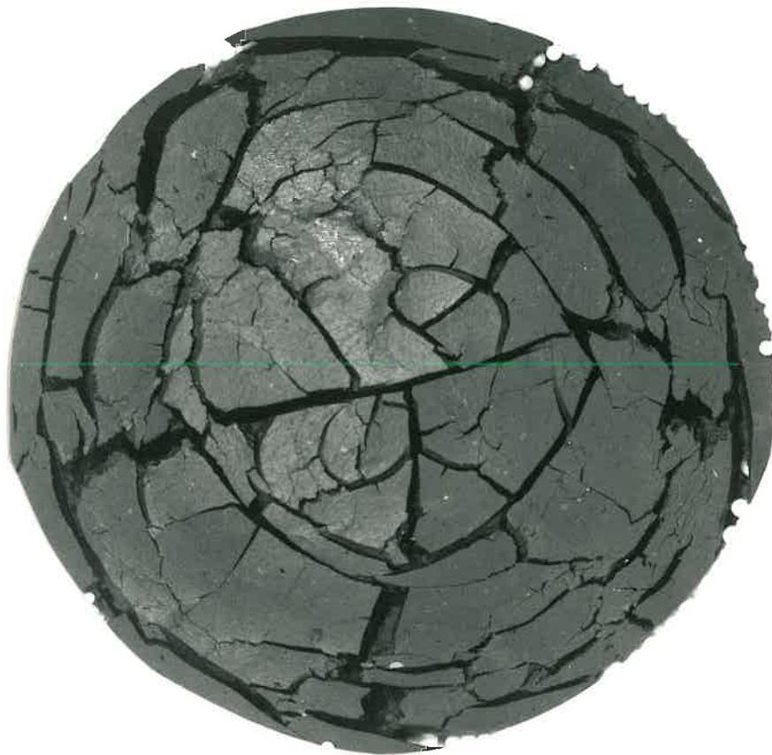
**Photo 2a : Morphologie fissurale avant dessiccation.**
