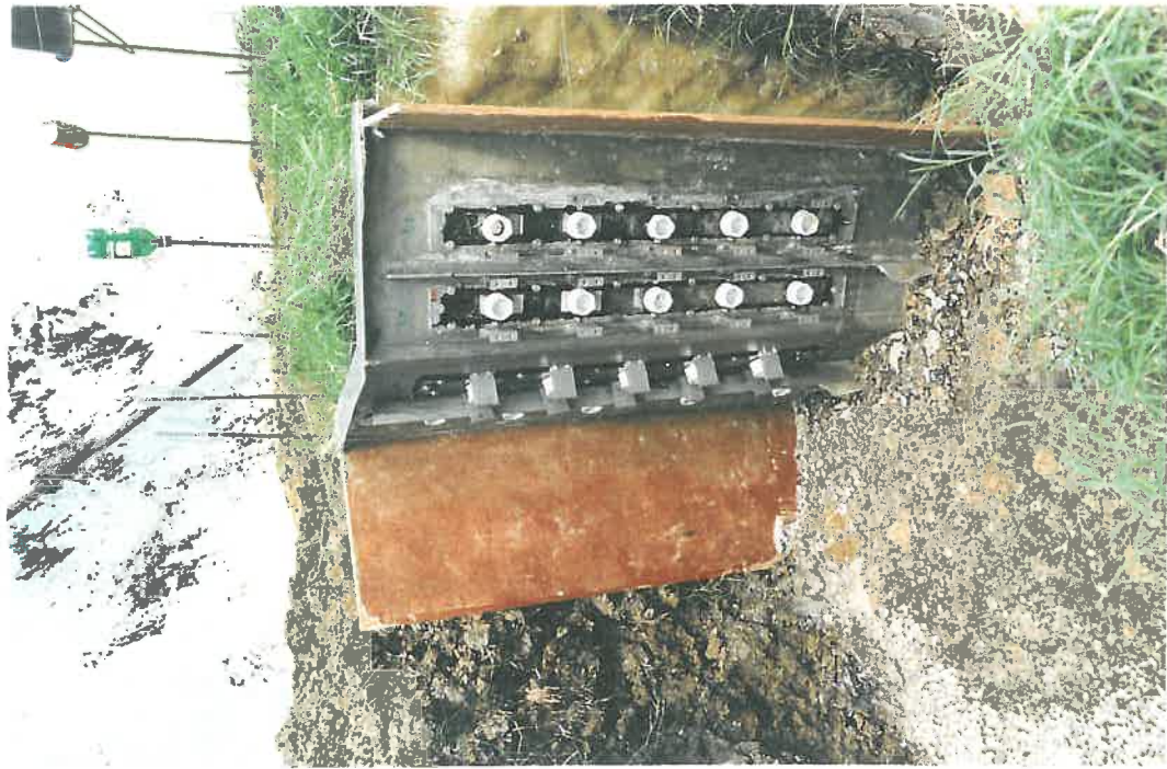
Photo L-1 : mise en place du Vertiscope : plaque inox et résinage, Gardel-INRA.
