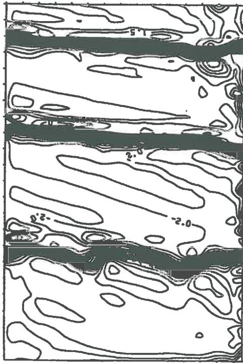
FIG. 6.17 - Résultat d'inversion conditionnelle pour l'exemple 1. La condition amont est donnée à partir du champ de perméabilité a priori.
