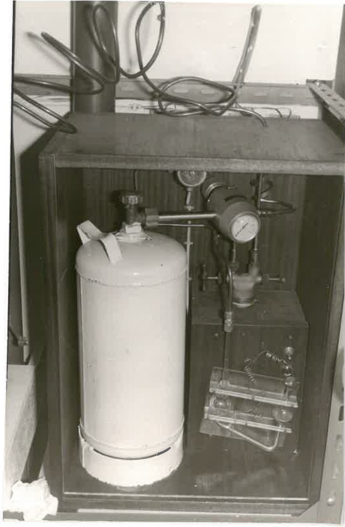
Photographie n°2 Dispositif permettant l'obtention de faibles débits gazeux
