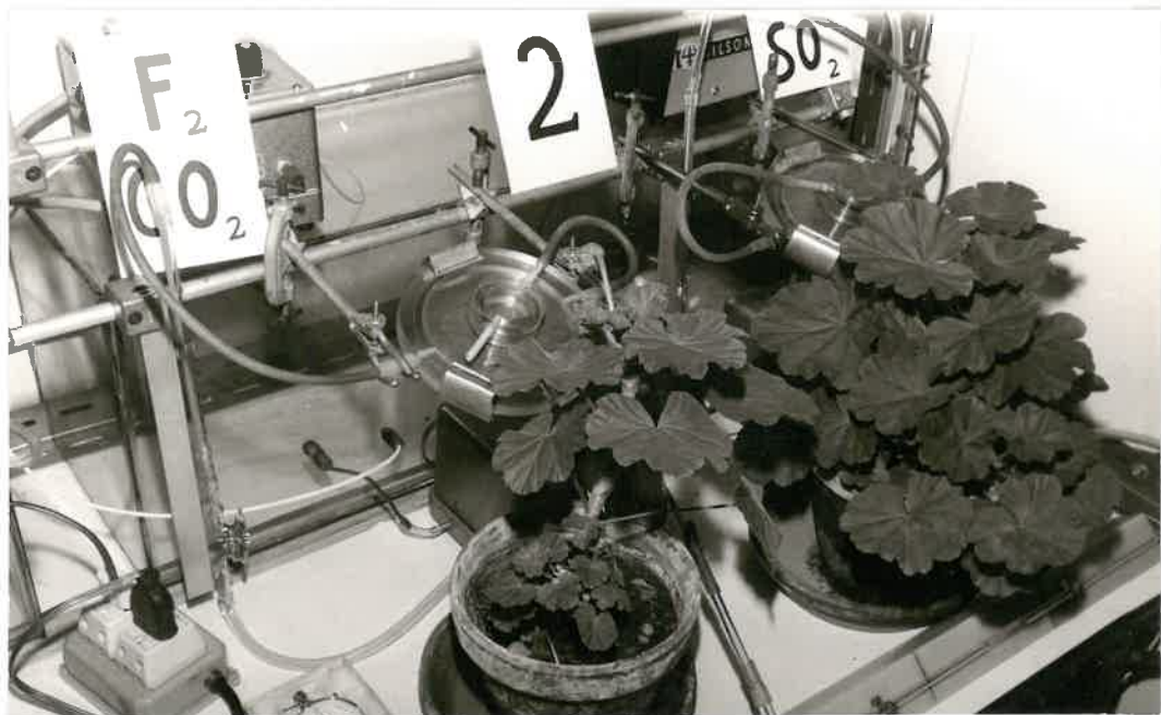
Photographie n°3: Détail du dispositif expérimental montrant l'adaptation du poromètre
