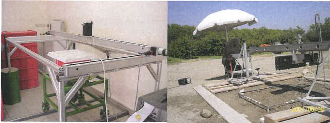
Figure 3. deux laser mètres ; à gauche pour une maquette au labo [17] en trois dimensions et à droite sur une seul transect
