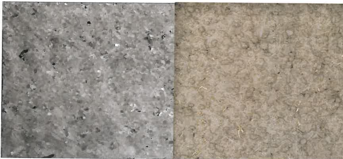
Figure 11. État final de la surface du sol (droit), MNT obtenu par stéréo-photographie (gauche).
