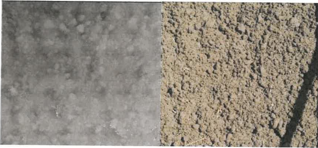
Figure 10. État initial de la surface du sol (droit), MNT obtenu par stéréo-photographie (gauche).
