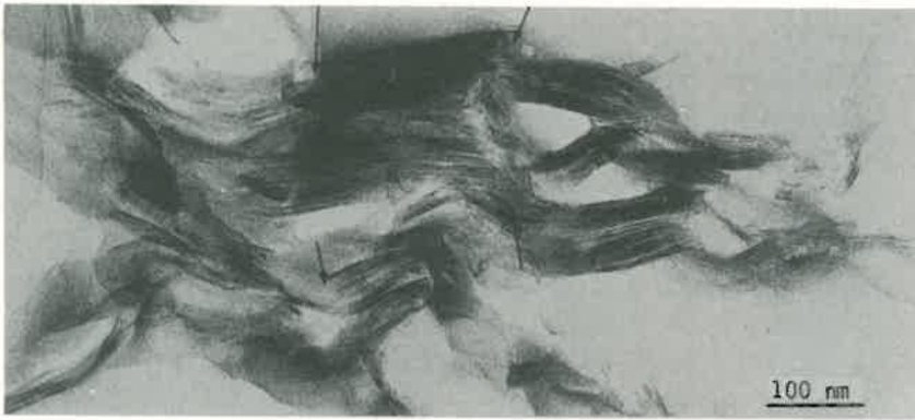
Fig.VIII.2 - Organisation interne des particules libres les plus grossières de la montmorillonite de Belle Fourche Na, NaCl 10^{-3}\text{M} , P = 0,032 bar. L'observation a été réalisée préférentiellement suivant la tranche des feuillets (MET)
