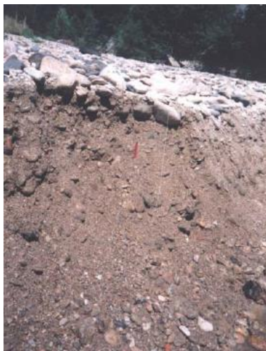
Figure 36 Exemple d'armure laissant apparaître la sous-couche d'éléments plus hétérogènes (Malavoi et al., 2011) © J.R. Malavoi
