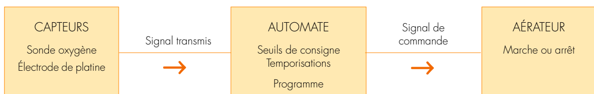
Figure III.3. – Chaîne d'automatisation par asservissement ou régulation
