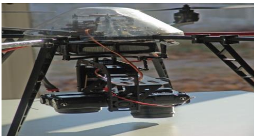
Support du drone sur lequel sont fixées les caméras
