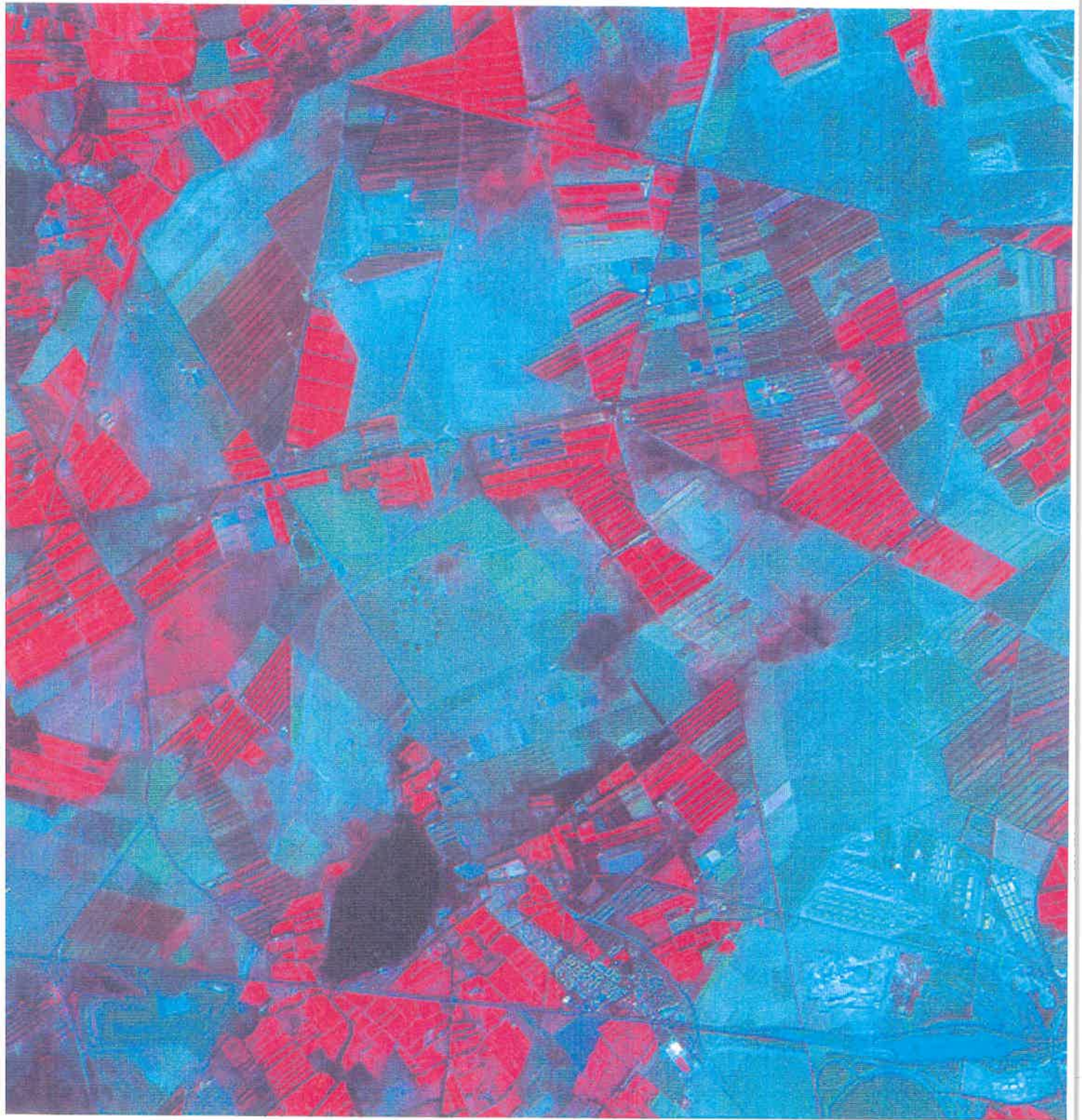
Figure 4: Même extrait de la scène SPOT acquise le 16 Octobre 1989 que pour la figure 3, mais après correction de la FTM. (Copyright SPOT IMAGE)
