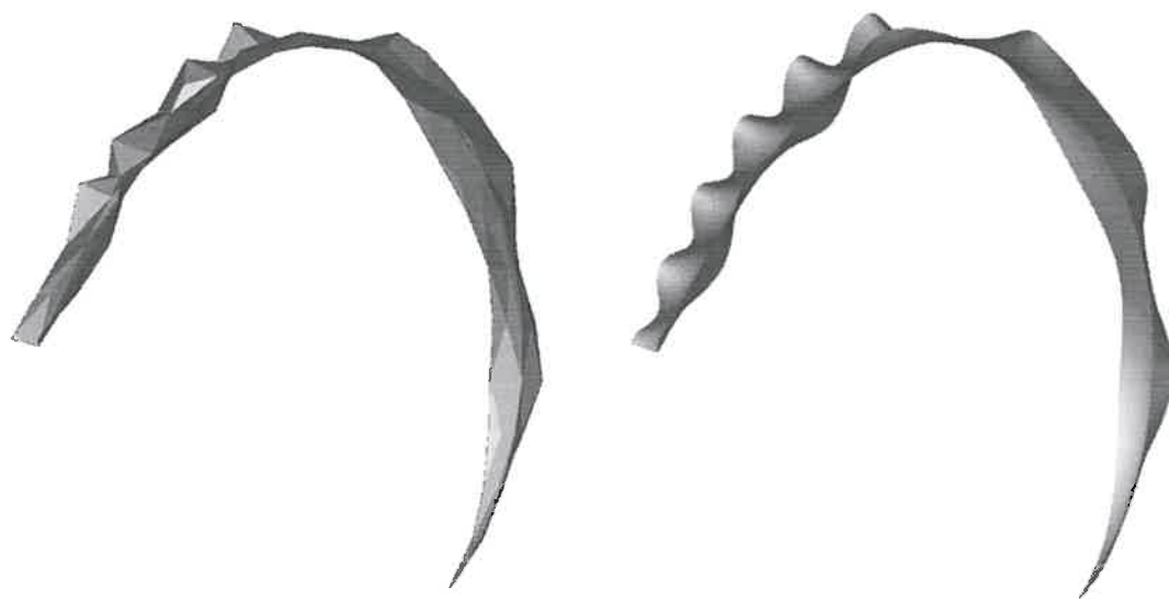
FIG. 5.1 – Découpage en triangles d'une feuille. Dans l'image de gauche, le plus grand côté du plus grand triangle mesure 5cm. L'approximation est médiocre en terme de distance ; les normales sont très mal représentées. Dans l'image de droite l'approximation est bonne en terme de distance comme en terme de normale. Le nombre de triangles par contre (plus de 10000), rend prohibitif la représentation d'une parcelle.
