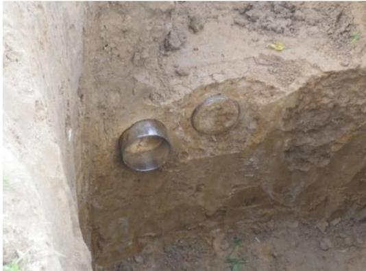
Les cylindres utilisés ont un diamètre intérieur de 8 cm, une hauteur de 5 cm et sont en acier inoxydable. Ils peuvent contenir un volume de sol de 250 ml. Cette méthode de prélèvement au cylindre permet d'obtenir des échantillons de sol non perturbés, dont la structure est préservée (figure 7).
