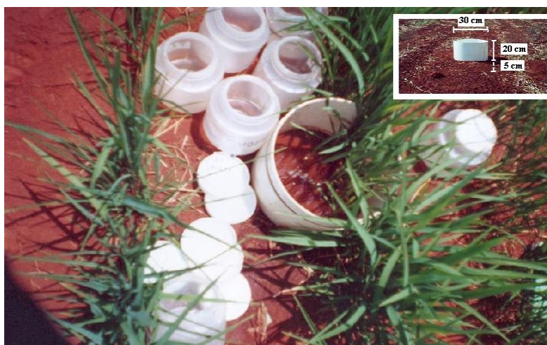
Figure 23 Détermination de la capacité d'infiltration du sol superficiel, méthode Beerkan.
