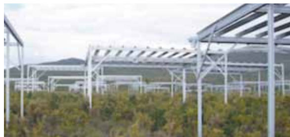
Dispositif d'exclusion de pluie dans un écosystème de garrigue sur le massif de l'Etoile à Marseille.
