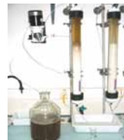
Fractionnement de la matière organique dissoute par passage de l'échantillon sur des résines chromatographiques.
