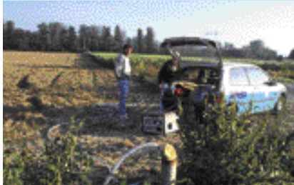
Le pompage d'eau souterraine dans un piézomètre permet d'effectuer des analyses de qualité, par exemple sur les nitrates, facteurs d'eutrophisation
