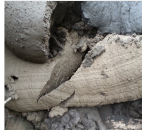
Boues chaulées issues d'un traitement classique (en haut) et du mélangeur Irstea (en bas).
