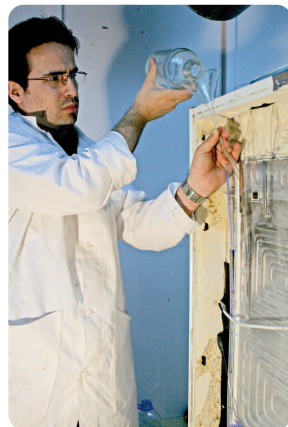
Intégration de matériaux à changement de phase (PCM) sur réfrigérateur expérimental ■ Madeleine Carrouée
