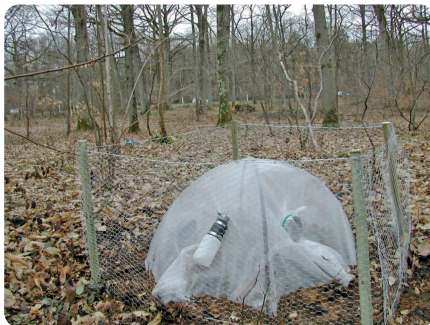
Échantillonnage des insectes saproxyliques émergeant des souches au moyen d'une nasse d'émergence dédiée ■ Christophe Bouget
