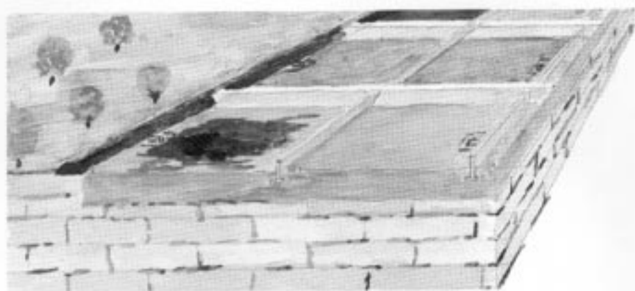
Figure 1 : Un dispositif d'infiltration percolation. Dans ce cas, l'eau est épurée à travers un massif de sable rapporté et poursuit son infiltration à travers une formation calcaire.
