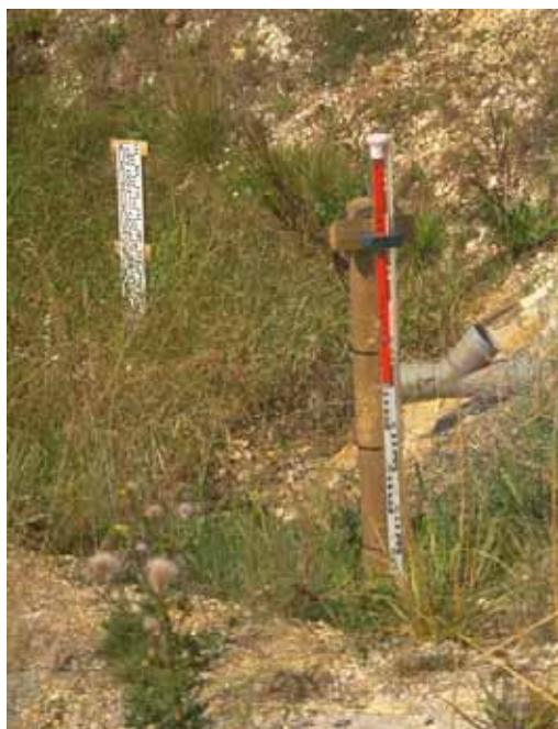
Photographie 16 : exemple de dispositif de relevé des niveaux maximaux atteints implanté sur un ouvrage anti-érosif de l'aménagement des ravines de l'Andelle. La couleur rouge indique que le niveau de l'eau n'a pas atteint cette partie de la règle.
