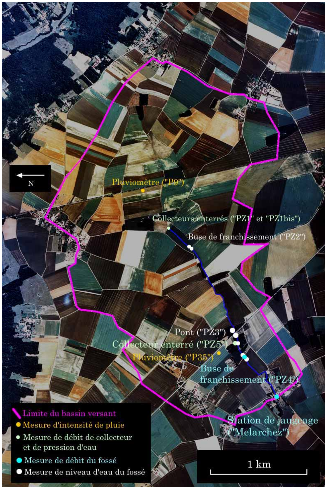
Photographie 4 : photographie aérienne du bassin versant du ru de Fosse Rognon, limite indicative du bassin versant et localisation de points de suivi expérimental. Le fossé s'écoule vers l'Ouest (bas de la photographie).
