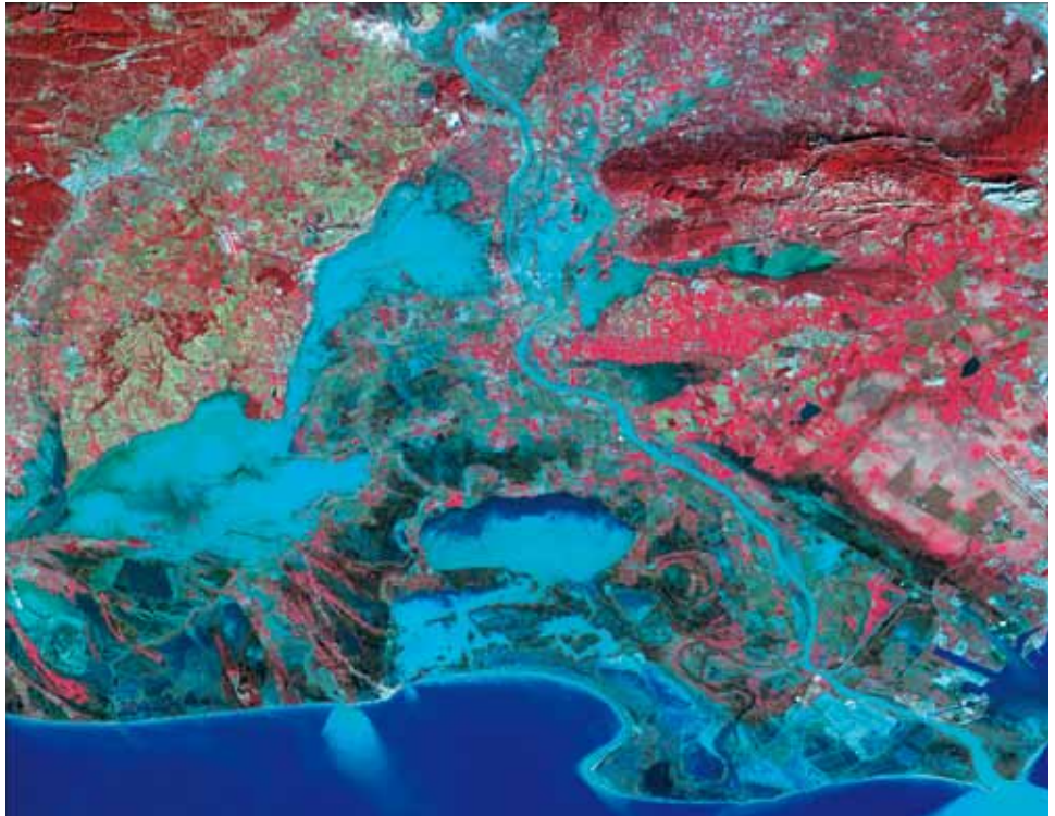
Photo 1 – Inondation du delta crue décembre 2003, 7 décembre 2003 (Spot 4,20 m de résolution). Le franchissement des trémies de la voie ferrée a permis l'inondation du Trébon et du Marais des Baux en rive gauche du Rhône. Les brèches sur le Petit Rhône ont entraîné l'inondation de la Camargue gardoise. © CNES 2003 - distribution Spot image - création Spot image/ EMM
