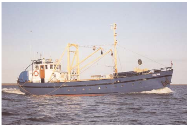
Figuur 52 Het onderzoeksschip Stern levert sinds 1983 het merendeel van de onderzoeksgegevens van het IJsselmeer. Midscheeps is langs de railing nog net de 8-m lange boom van de grote kuil (Figuur 31) te zien; midden op het dek een vis-sorteer-tafel. (foto Marcel de Vries)
