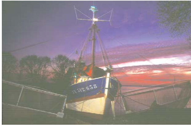
Figuur 13 Een Franse pibalour . Het net wordt door de boot voor zich uitgeduwd. Voor deze foto is het net iets boven het water uitgetild. (foto Gerard Castelnaud) A French pibalour. The net is pushed in front of the boat, just under the water surface.
