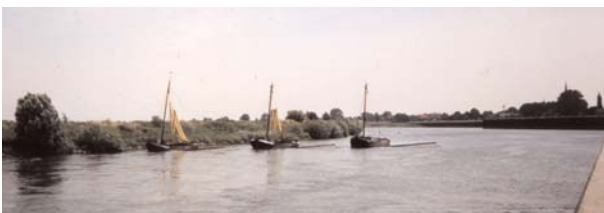
Figuur 35 Een drietal schokkers ligt voor anker op een vaste plaats in de rivier, met een ankerkuil terzij. De wegtrekkende schieraal laat zich op de stroom voortdrijven, en zwemt recht de ankerkuil in, die hier aan bakbord (voor de kijker rechts) van het schip nog juist aan het wateroppervlak zichtbaar is. Bij twee schepen hangt het net in de mast te drogen. (foto Jan van Willigen)
