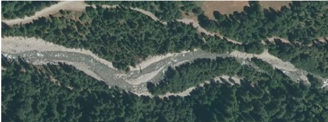
Figure 6 : Exemple de lit de type 2 - cours d'eau à bancs alternés- (l'Onde, commune de Vallouise, 05).
