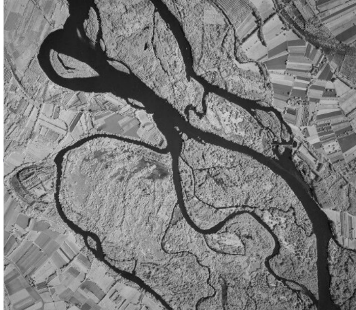
Figure 10 : Exemple de lit de type 5 - anabranché (le Rhône dans le secteur de Brégnier-Cordon, 01-38, en 1970) (source : Géoportail).
