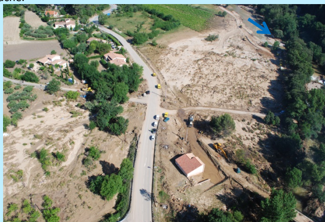
Figure 27 : Fortes vitesses en lit majeur rive droite de la Nartuby (au niveau du pont de la Clappe) mises en évidence par la reconnaissance de terrain après la crue de juin 2010 (source : département du Var)
