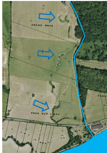
Figure 12 : La Gourgeonne (70) rectifiée en amont de sa confluence avec la Saône : traces d'un ancien lit visible sur photographie aérienne et cadastre (source : IGN)
