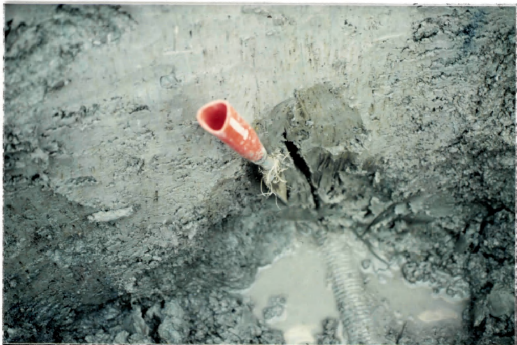
Photo 14 - Seule une légère fente au-dessus du drain témoigne du passage du côtre sous-soleur dans ce matériau plastique.
