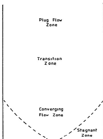
Fig. 3. Diagram of flow zones.
