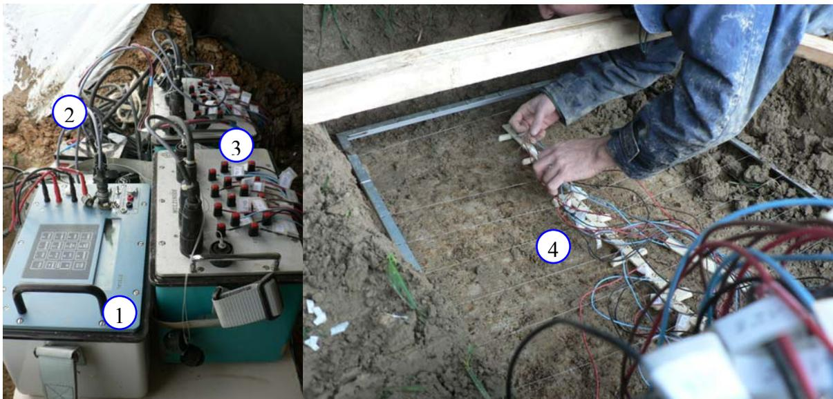
*Figure II-7 : Description du matériel utilisé pour les mesures de résistivité électrique*
