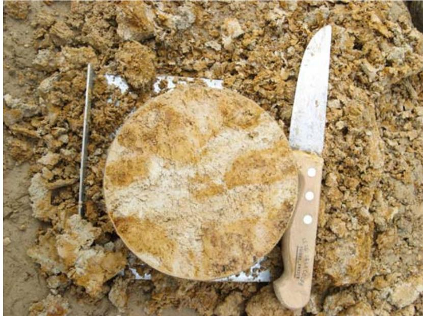
*Figure I-5: Cylindre d'un diamètre de 15 cm considéré comme un volume d'horizon pour y effectuer des déterminations de la conductivité hydraulique à saturation et prélevé dans un horizon hétérogène*
