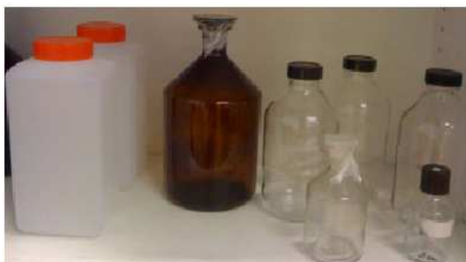
Figure 42. Flaconnages nécessaires pour le transfert des échantillons vers le laboratoire accrédité
