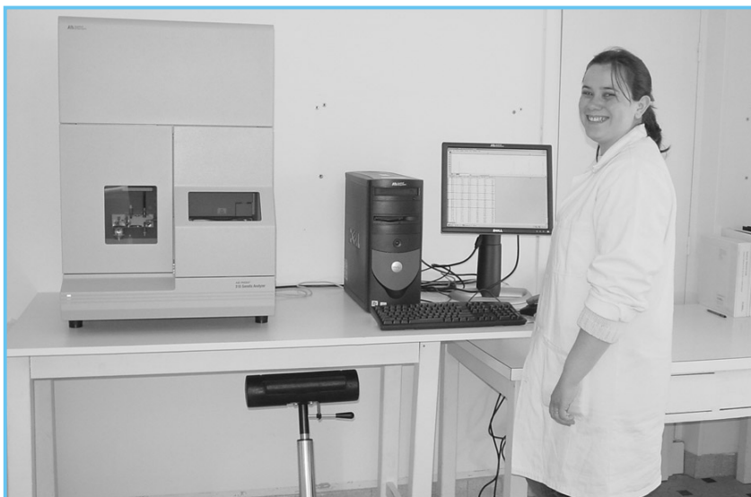
Figure 5 : Séquenceur ABI310, utilisé par le laboratoire de biotechnologie de l'AFOCEL pour des génotypages réalisés à l'aide de marqueurs microsatellites.
