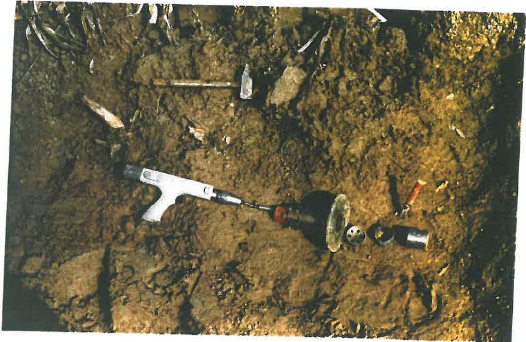
Photographie du pistolet de prélèvement pour les mesures de perméabilités
