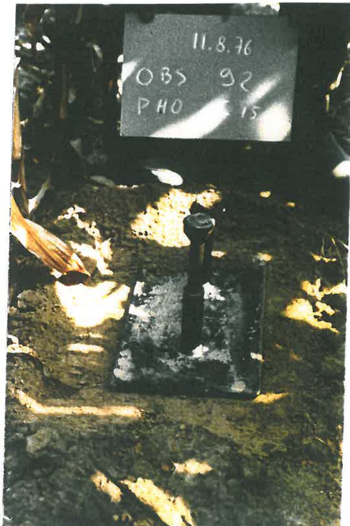
Préparation de l'emplacement (aplanissement et forage) pour les mesures avec la sonde TROXLER
