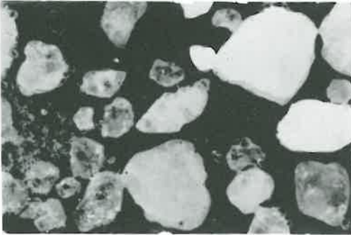
Matériau A : sable silteux. Agrandissement 5 fois.
