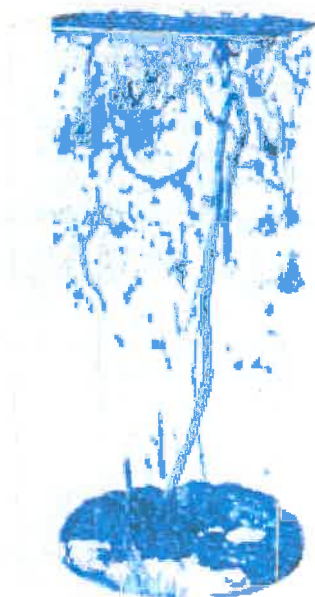
Figure I-6 : Image tridimensionnelle du sol par tomographie \u00e0 rayon X. (d'apr\u00e8s Delerue, 2001)
