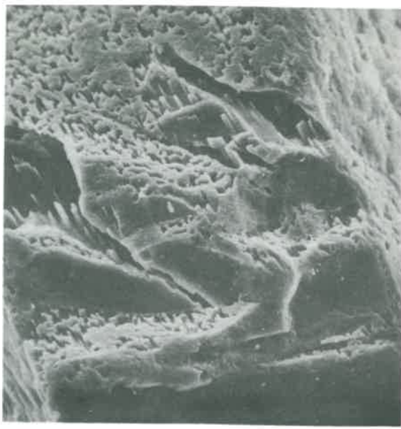
Cliché VIII-4 : Vue détaillée d'une face d'un cristal d'olivine après altération (1 cm = 40 \mu ).
