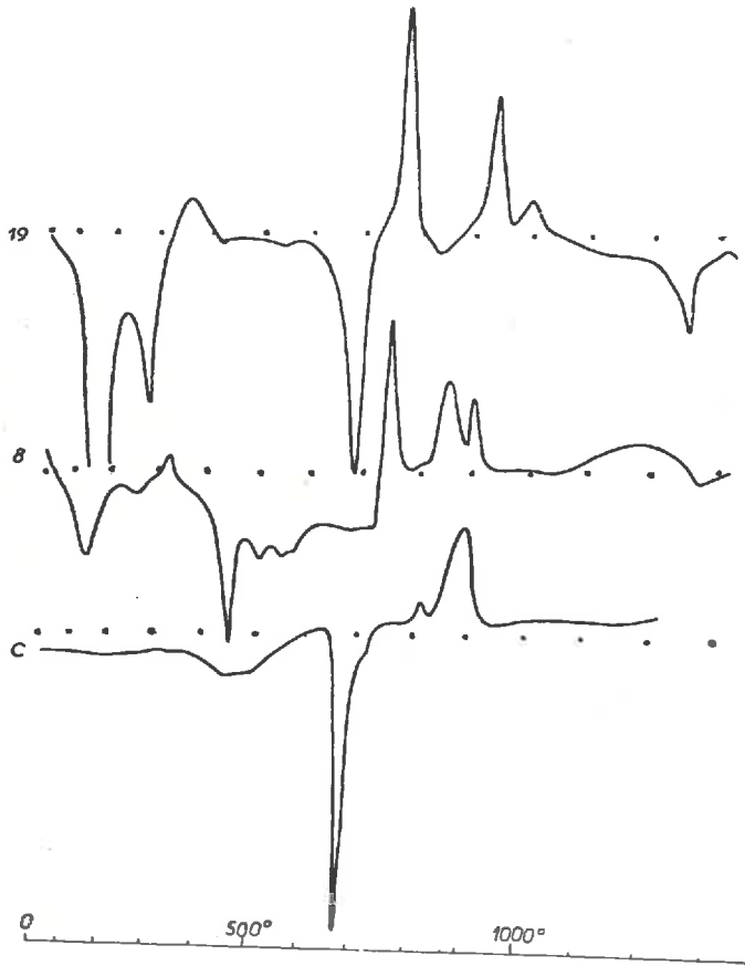
Figure 3 - Courbes d'analyse thermique différentielle des silicates de zinc hydratés.
