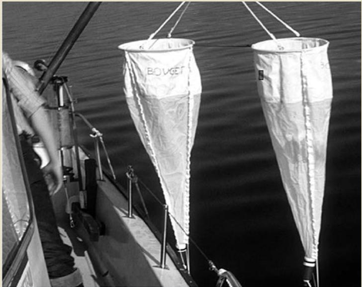
Filets jumelés permettant de capturer simultanément le phytoplancton et le zooplancton dans la même colonne d’eau.
