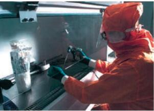
« Prélèvement d'un échantillon bactériologiquement contaminé dans un poste de sécurité microbiologique. Expérimentateur avec protection maximale. » *INRA mensuel*, n° 123, Les zoonoses. Recherches à l'Inra, Dossier juin 2005, p. 46. © Inra/Jean Weber.
