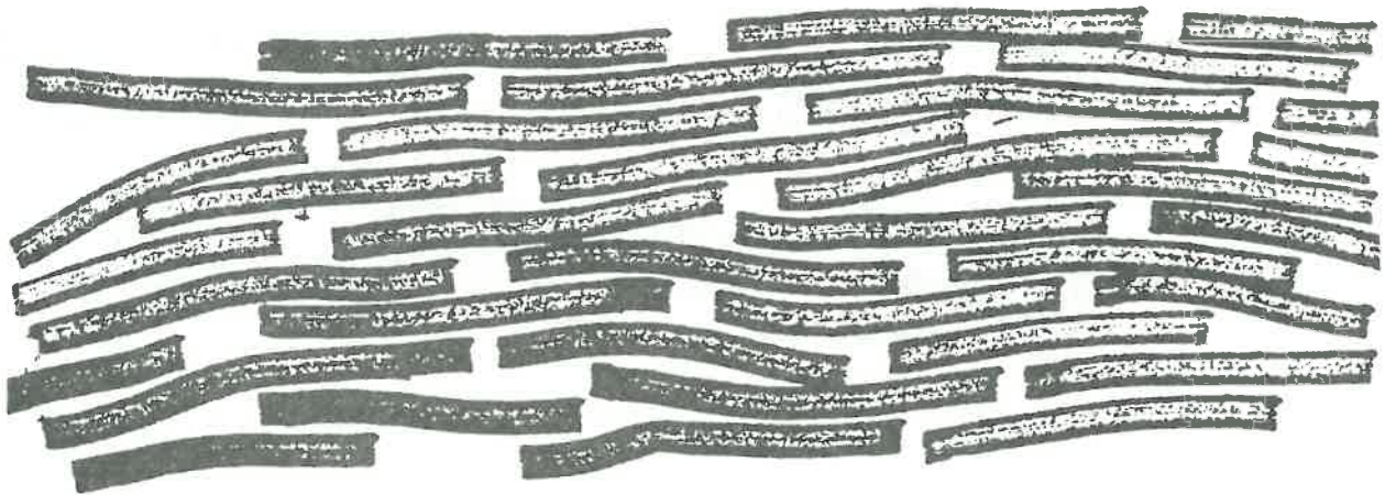
Fig XI-5 : (a) Représentation schématique (sinon caricaturale) d'une microtexture délaminée, fortement connectée, peu poreuse, et à porosité orientée.
