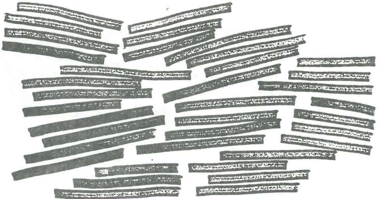
Fig XI-6 : (a) Représentation tout aussi schématique d'une microtexture empilée, peu connectée, à porosité élevée et omnidirectionnelle.
