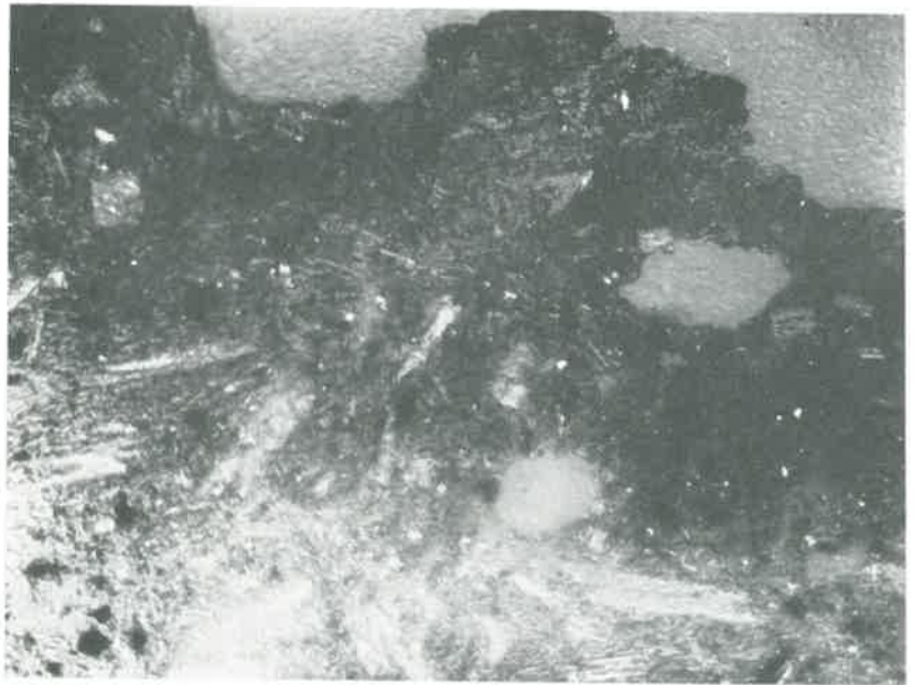
CLICHÉ VII. — Essai sur lave de Volvic — Aspect microscopique de la croûte d'altération (E) [L.N.] ( \times 85 ). On peut noter le maintien de la structure originelle et l'abondance des produits ferrugineux rouille
