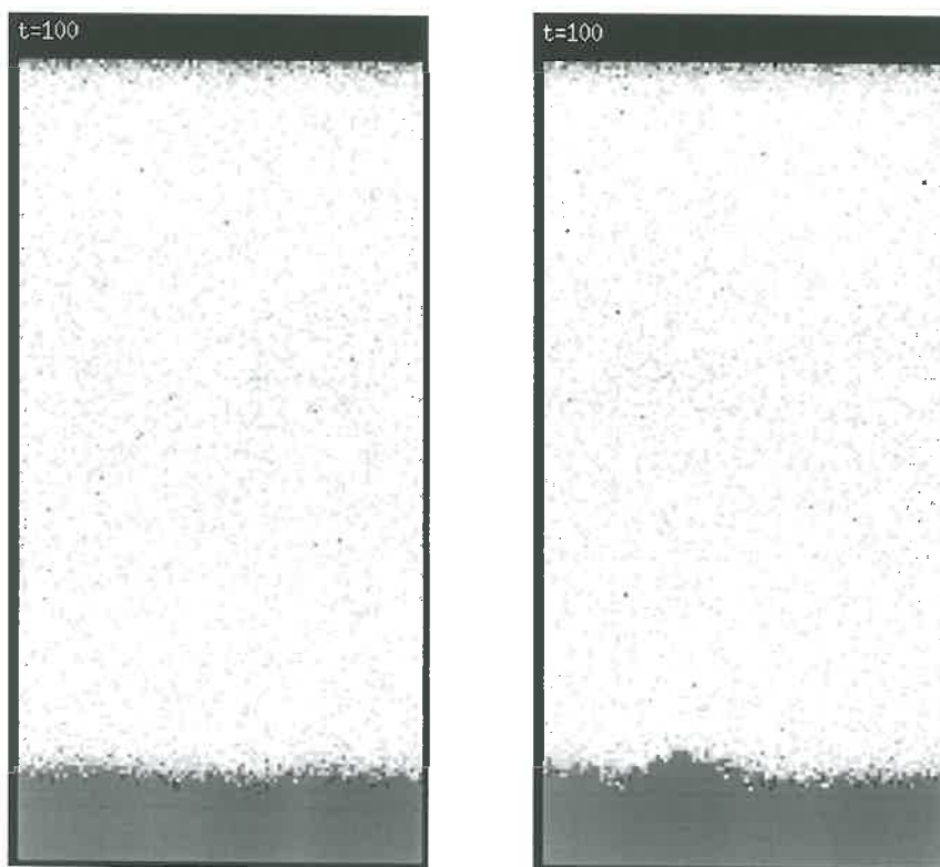
Figure 9.3 – Images en coupe verticale des simulations 3D de la rétention superficielle sous pluies pour les deux surfaces rugueuses expérimentales. Le système lisse (resp. rugueux) est représenté à gauche (resp. à droite) au temps 100 ut. La géométrie du réseau est de 100 \times 100 \times 200 \text{ ul}^3 .
