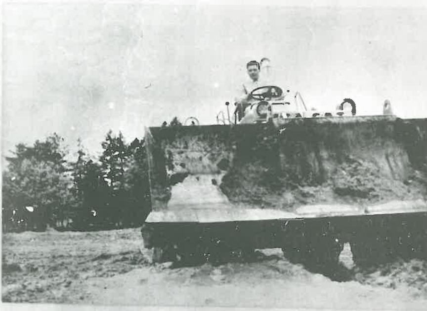
Photo 13 : essai de rupture de tapis sous l'action d'un bulldozer à pneus CAT 824.
