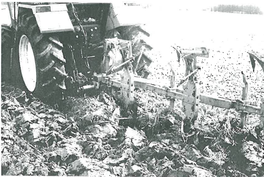
Figure A.IV.D14 : Capteur dynamométrique sur le barreau d'attelage du tracteur utilisé sur la parcelle de Palaiseau (91)
