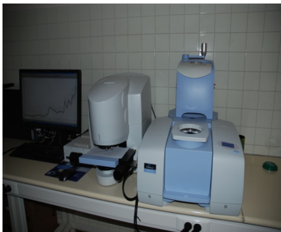
Figure 9 : Spectromètre avec le module pour le proche infrarouge et au-dessus le module pour le moyen infrarouge
