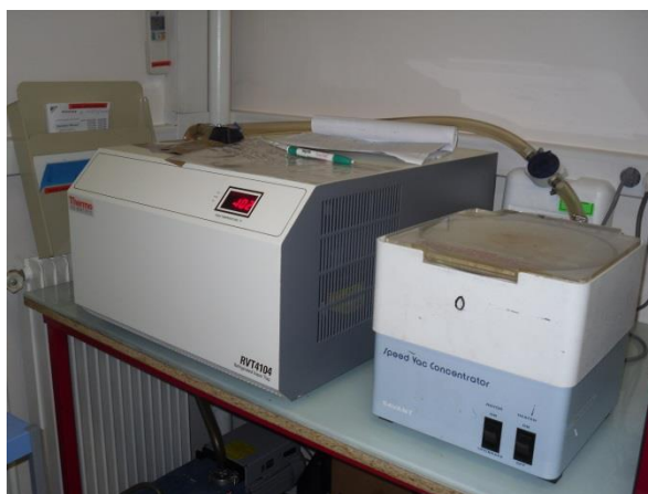
Figure 18 : Système d'évaporation sous vide "Speed-Vac" (Savant, Speed-Vac SVC100H)
