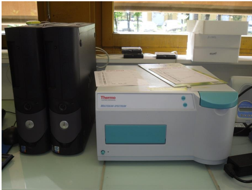
Figure 14 : Spectromètre UV/Visible utilisé pour l'analyse des lignines solubles
