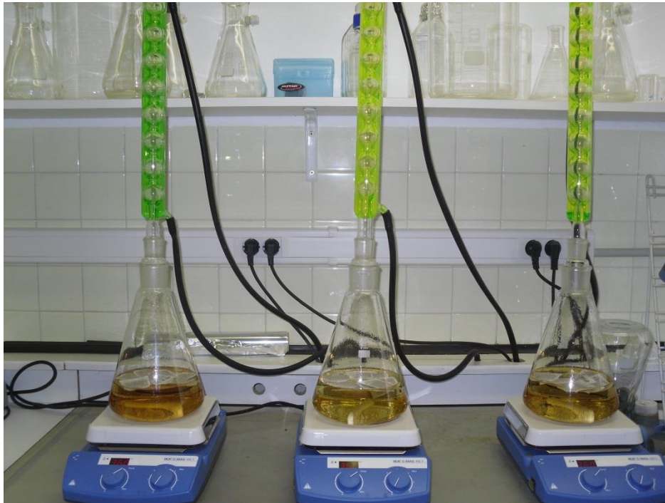
Figure 11 : Etape d'extraction des composés solubles présents dans le bois de robinier
