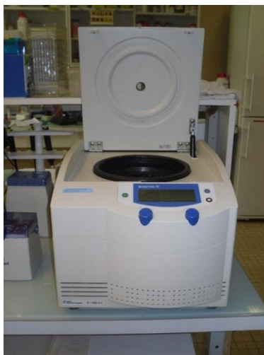
Figure 17 : Centrifugeuse réfrigérée à 4°C
