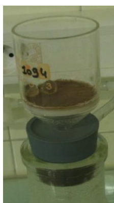
Figure 13 : Creuset sur lequel est déposé le résidu de lignine "Klason" après la filtration
