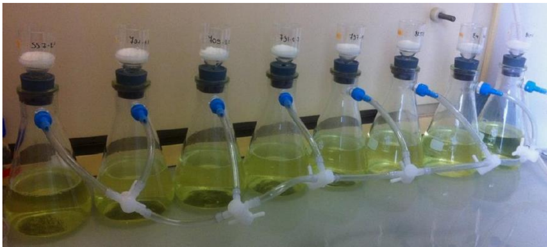
Figure 15 : Rampe de filtration utilisée pour les dosages de lignines et de celluloses
