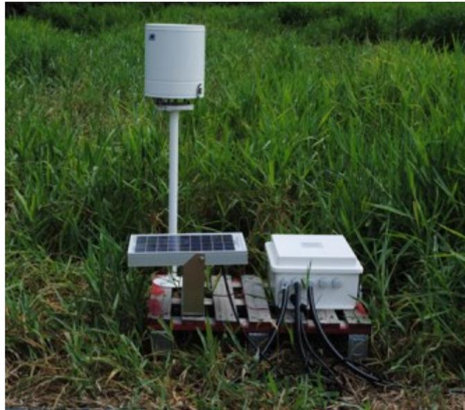
**Figure 20.** Pluviomètre 3029 (Précis mécanique), sondes TDR CS616 et capteurs température 108 reliés à une centrale d'acquisition des mesures CR1000 (Campbell Scientific) alimentée par panneau solaire (photographie : Viard).
