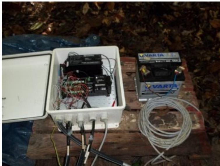
**Figure 21.** Sondes TDR CS616 et capteurs température 108 reliés à une centrale d'acquisition des mesures CR1000 (Campbell Scientific) alimentée par batterie (photographie : Petitjean).
