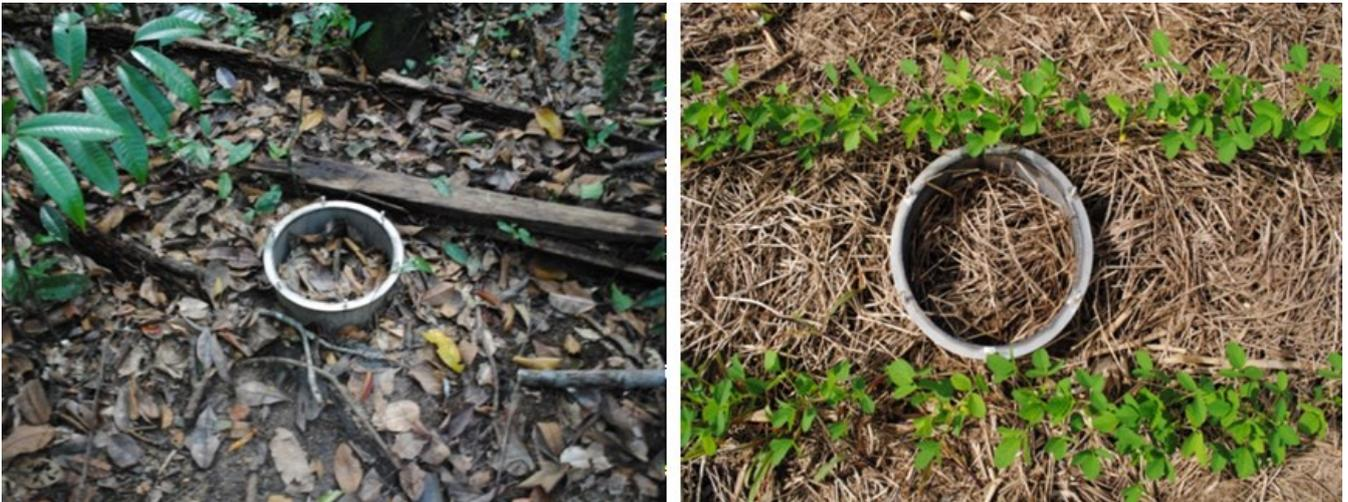
**Figure 26.** Bases des chambres de prélèvements de gaz à effet de serre, dans une parcelle de forêt (à gauche) et dans l'inter-rang d'une parcelle de soja (à droite) (photographies : Viard).
