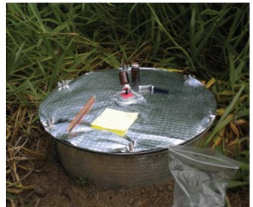
**Figure 23.** Schéma et photographie d'une chambre de prélèvement de GES (photographie : Viard, 2010).
