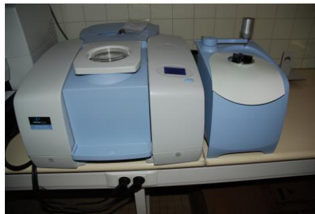
Figure 13 : Spectrophotomètre infrarouge ( Spectrum 400 , INRA Orléans)
